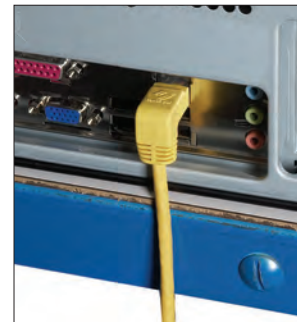
下向きケーブル：コネクタのラッチ部を下向きにするとケーブルは下に抜けます。 (EVNSL24E-0003-90DS)
