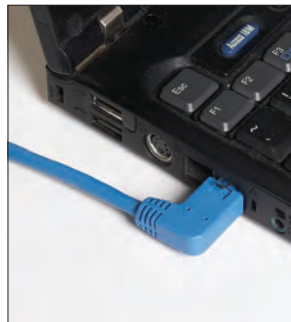
右向きケーブル：コネクタのラッチ部を上向きにするとケーブルは向かって左に抜けます。 (EVNSL21E-0003-90RS)
