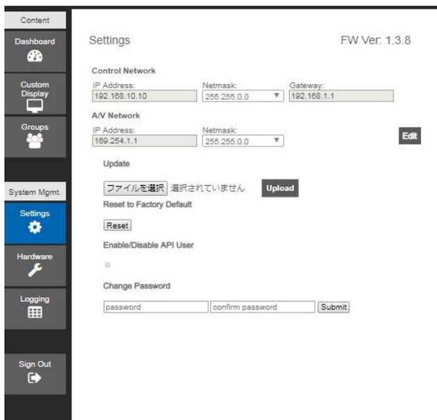
A/V Networks の IP Address は自動設定アドレスです。このネットワークに接続されるトランスミッタ/レシーバはこの自動設定アドレスを使っていて起動時に空いているアドレスを見つけ自分に割り当てます。但し、コントローラのアドレスは固定です。
